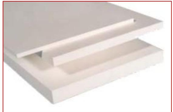
Über 1200°C wandelt sich die Struktur in eine kristalline Struktur und wird spröde. Wenn die thermische Belastung nur punktuell auftritt, behält das Restmaterial seine originären Eigenschaften. CP-Ceram 100 zeigt eine außerordentliche, nicht benutzende Fähigkeit beim Kontakt mit geschmolzenen NE-Metallen. Dies ermöglicht einen vielfältigen Einsatzbereich.
